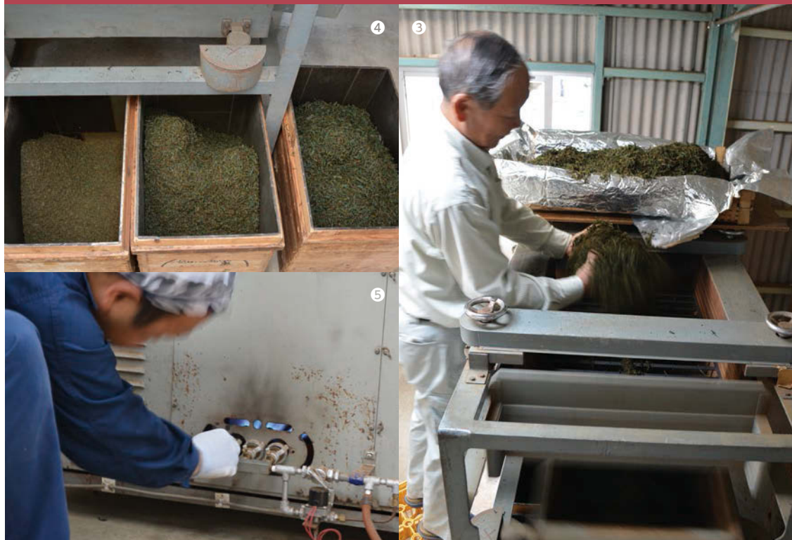
①「萎凋」後の茶葉を、「揉捻」機に入れる ②「揉捻」途中の茶葉 ③「揉捻」後の茶葉をふるいにかける ④茶葉の大きさに別に分けた状態 ⑤ボイラー点火。この火加減が最も難しいという
