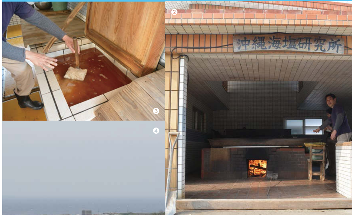
① 交代で煮詰める「釜炊き」 ② 釜炊き後、脱水槽に移す ④ 粟国島北部の「風」が欲しくて、北岸に「かん化式塩田タワー」を建造。草原と海と空が広がる
