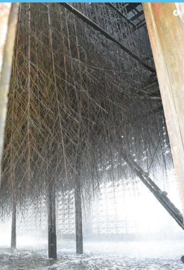
①「かん化式塩田タワー」。穴のあいたブロックできている ②沖縄海塩研究所の奥原リーダー ③栗国島北岸の風 ④15,000本の逆さまに吊るされた竹。シャバシャバシャバ……と海水が落ち続ける
