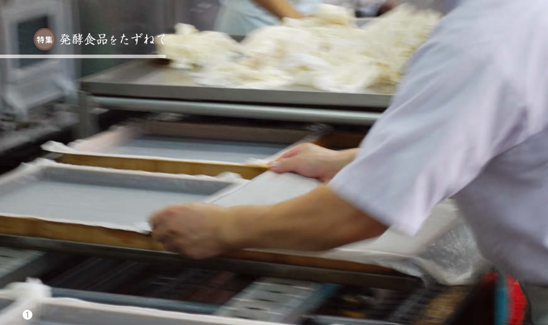
①一瞬の職人業で木枠に布をヨレずに敷く ②生地を木枠に流し込む ③一直線状の専用蒸し器 ④くず餅の命「弾力」を厳しくチェック ⑤黒蜜が絡むよう台形にカット
