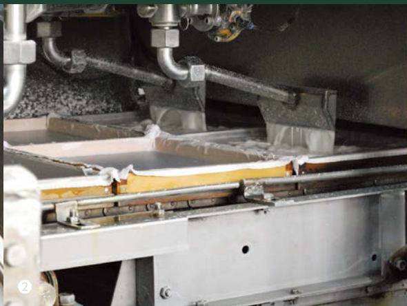
①一瞬の職人業で木枠に布をヨレずに敷く ②生地を木枠に流し込む ③一直線状の専用蒸し器 ④くず餅の命「弾力」を厳しくチェック ⑤黒蜜が絡むよう台形にカット
