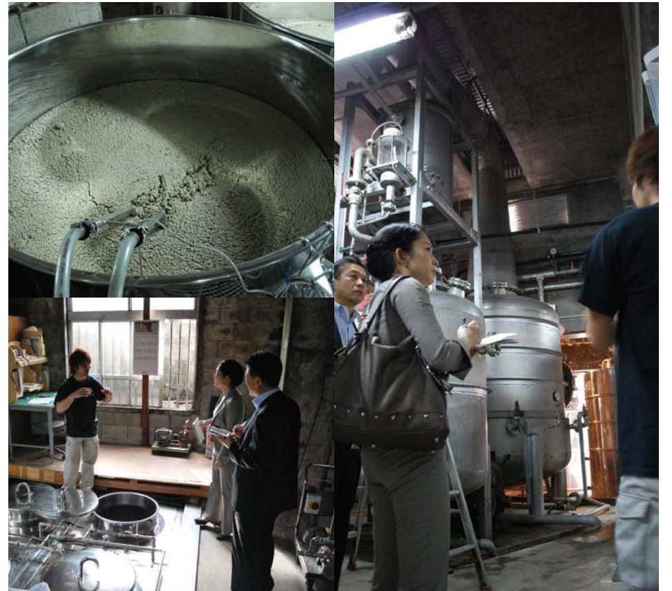
右写真の、細い管が上に向かって伸びているタンクで蒸留する
